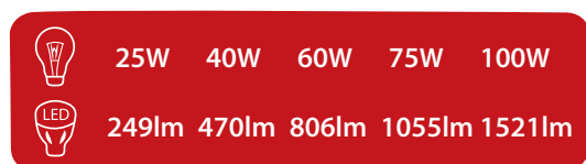
Abb. 50 | Vergleich der herkömmlichen Glühbirne mit der Lichtstärke einer LED Lampe
