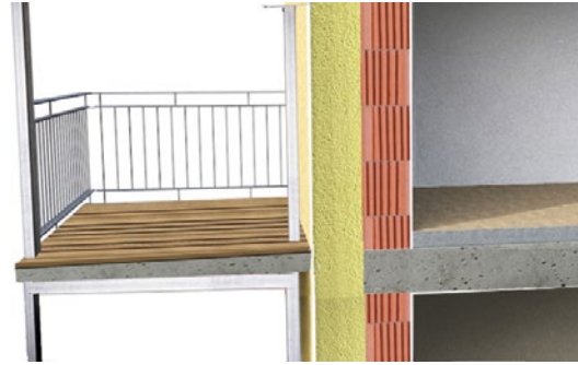
Abb. 25 | Vorgestellter Balkon – keine Wärmebrücke
