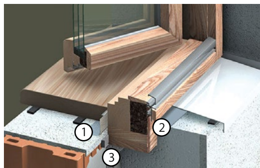
Abb. 21 | Dreiteiliger Baukörperanschluss / RAL Montage
